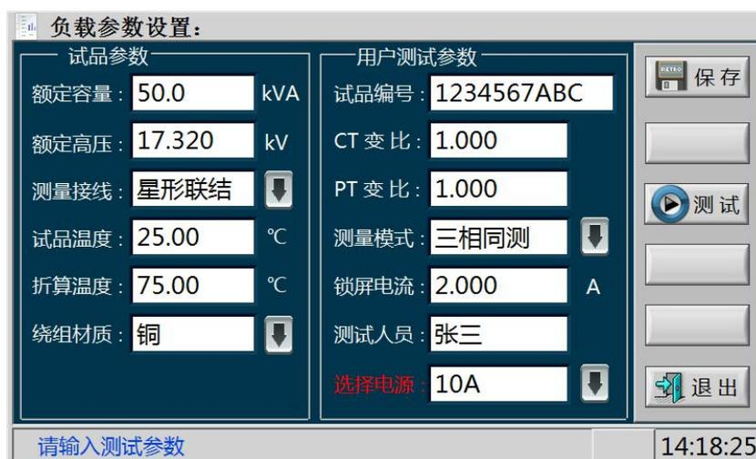
在参数设置界面，仪器显示最近保存参数，若与当前试品参数不一致，点击触控界面上的输入框或图标按钮重新设置即可，参数设置完成后，点击“保存”图标按钮保存当前参数，点击“测试”图标按钮进入测试界面。
